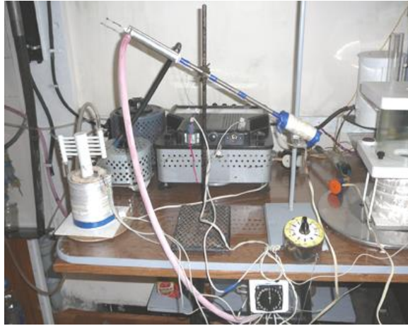
Рис. 1. Експериментальний стенд для досліджень теплофізичних характеристик теплових труб
