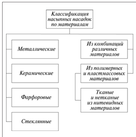
Рис. 1. Классификация насыпных насадок для колонных аппаратов по материалам
