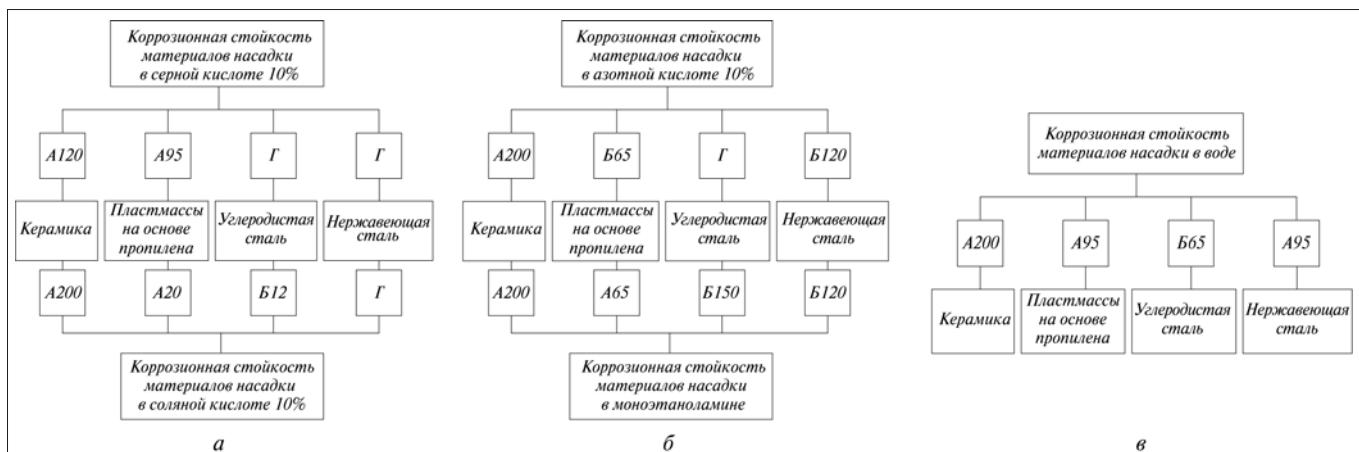
Рис. 3. Коррозионная стойкость материалов насадки в различных средах: а – серная и соляная 10%-ные кислоты; б – азотная 10%-ная кислота и моноэтаноламин; в – вода; (А – отсутствие изменений, Б – незначительные изменения, В – ограниченный срок службы, Г – применять не рекомендуется; цифра при букве обозначает температуру эксплуатации)
