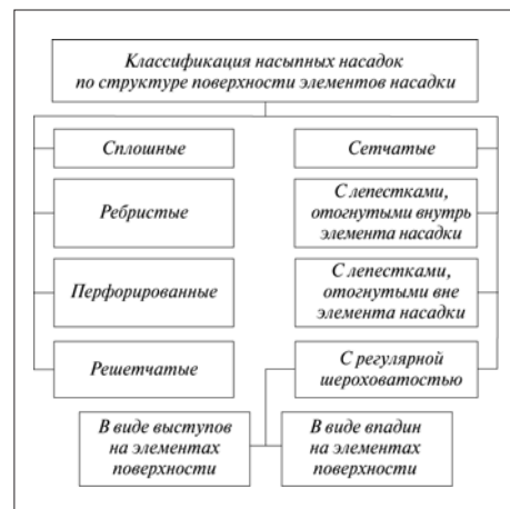
Рис. 5. Классификация насыпных насадок для колонных аппаратов по структуре поверхности элементов насадки
