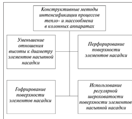
Рис. 9. Конструктивные методы интенсификации процессов тепло- и массообмена в колонных аппаратах с насыпной насадкой
