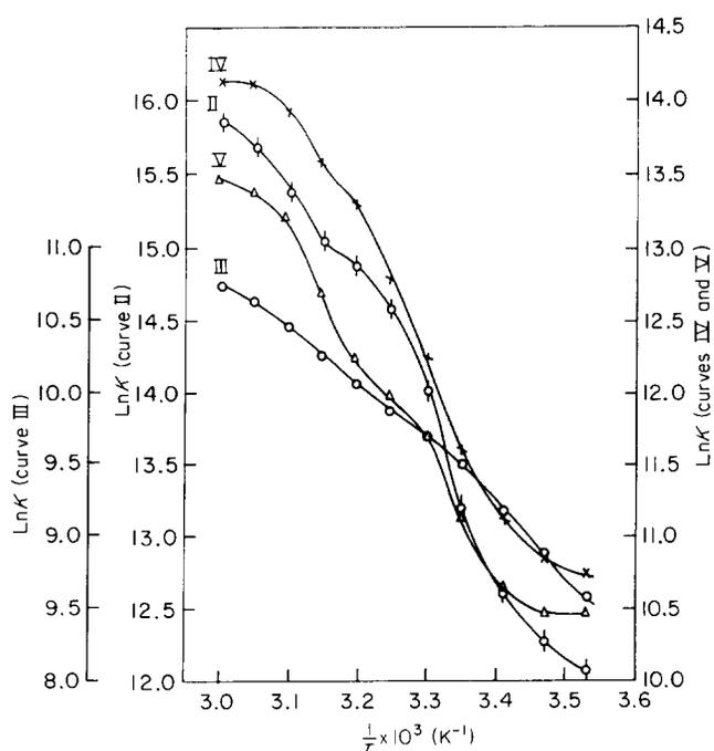
**Figure 1** Relationship between  $\ln K$  versus  $1/T$  for various complexation systems: (II) 1 um MA-AAm + 1 um PEI; (III) 1 um MA-AAm + 1 um PVP; (IV) 1 um MA-AAm + 0.56 um PEI + 0.44 um PVP; (V) 1 um MA-AAm + 0.56 um PVP + 0.44 um PEI
