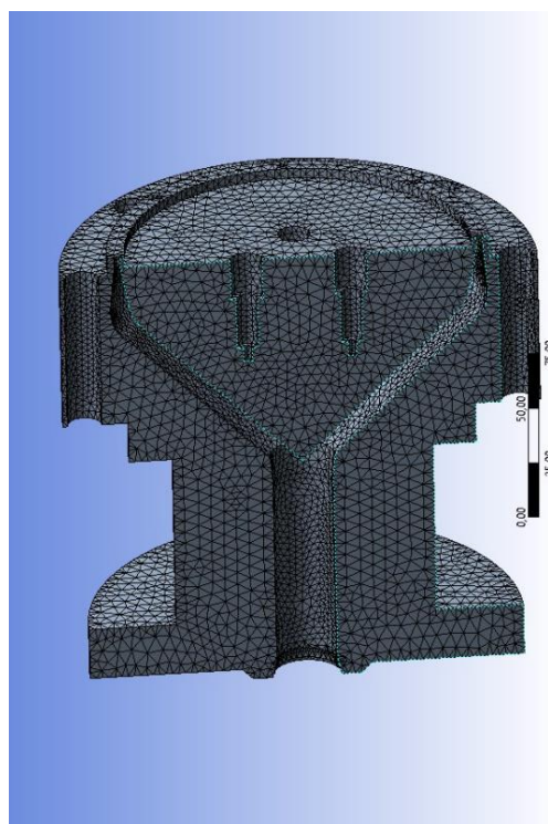
Рисунок 4. 1 - Скінченно-елементна сітка головки базової конструкції (91278)
