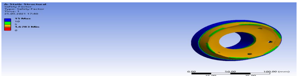
Рис. В.7 – Скріншот запасу міцності при 30 МПа
