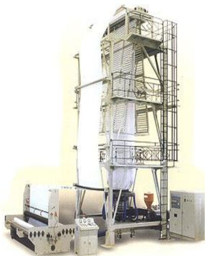
Рис.1.1 Установа для виробництва плівки рукавним методом з прийманням рукава вгору
