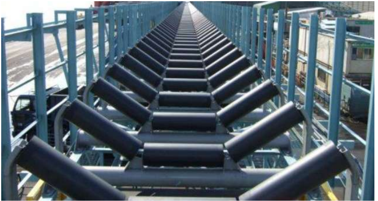
Рис. 1.4. Загальний вигляд конвеєрного ставу зі знятою стрічкою Роликоопора. (рис. 5.) Складається з роликоопор , і стійок. Стрічка рухається по роликоопорам конвеєрного става.
